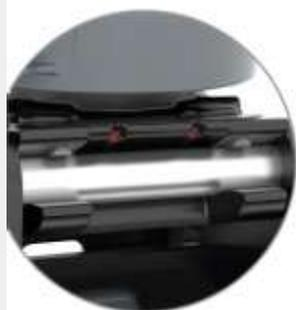
Передний замок S-LOCK с гидравлической быстроразъемной муфтой надежно фиксирует рабочее оборудование. Соединение гидравлических контуров герметичное.
