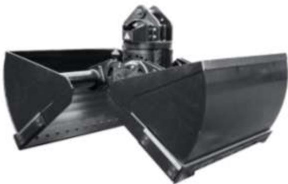
**Грейфер с модулем НРХ** — это универсальный грейфер для перевалки различных навалочных грузов, таких как щебень, уголь, песок, сера и т. д. Модуль абсолютно герметичен: грейфер можно безопасно использовать под водой и в условиях повышенной запыленности. Быстросменные челюсти позволяют обрабатывать материалы с различным удельным весом, что дает возможность использовать весь потенциал машины.
